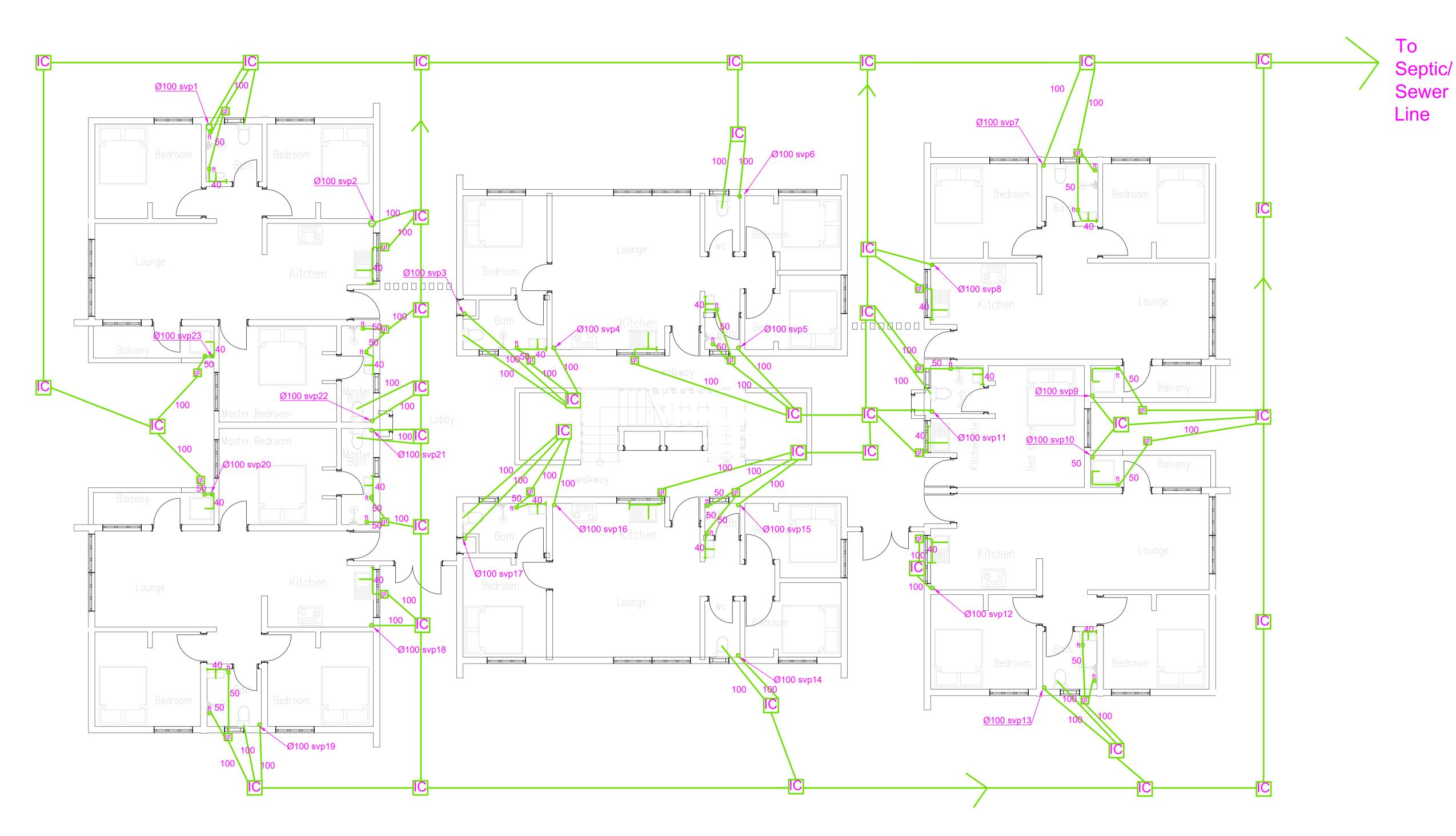
BLOCK B G+4 GROUND FLOOR DRAINAGE PLAN
