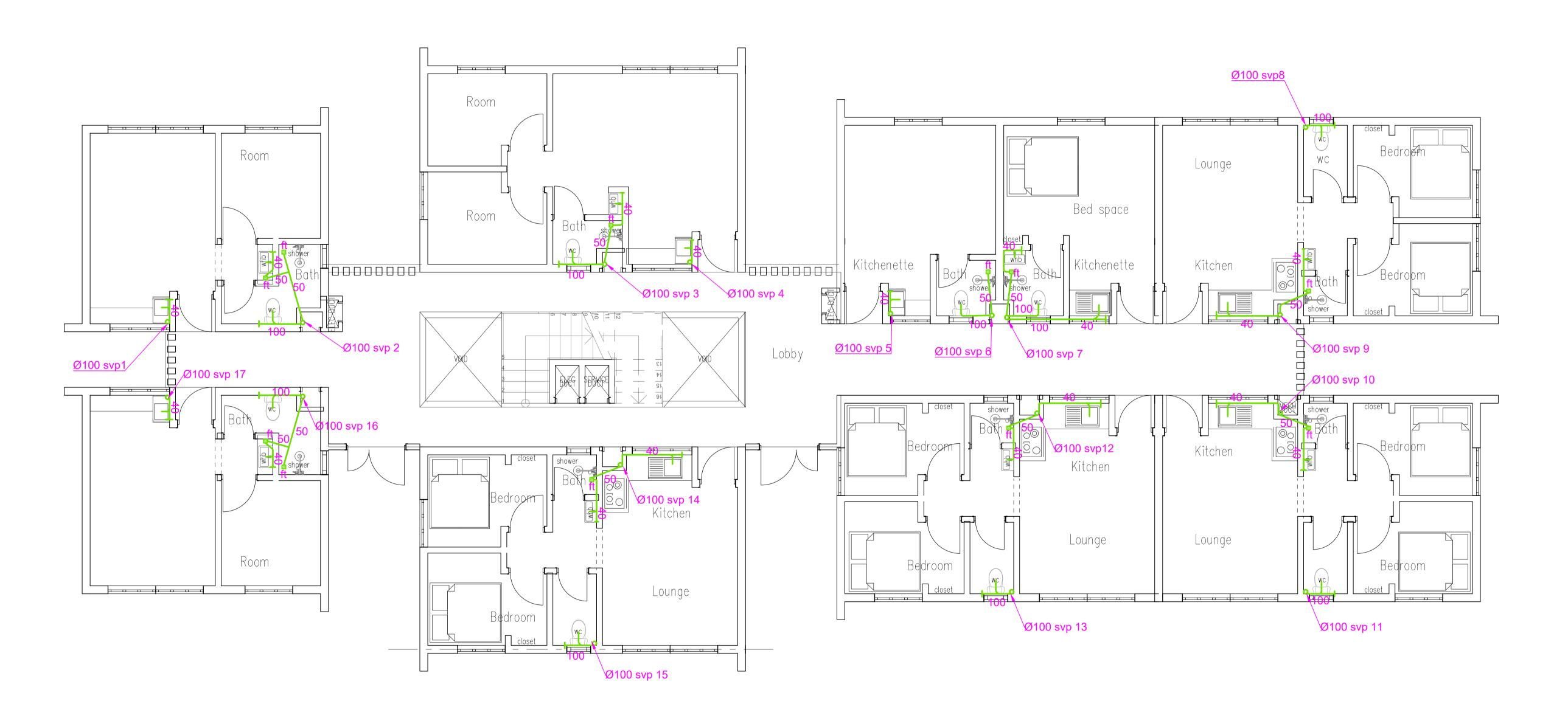
BLOCK A G+4 TYPICAL FLOOR DRAINAGE PLAN
