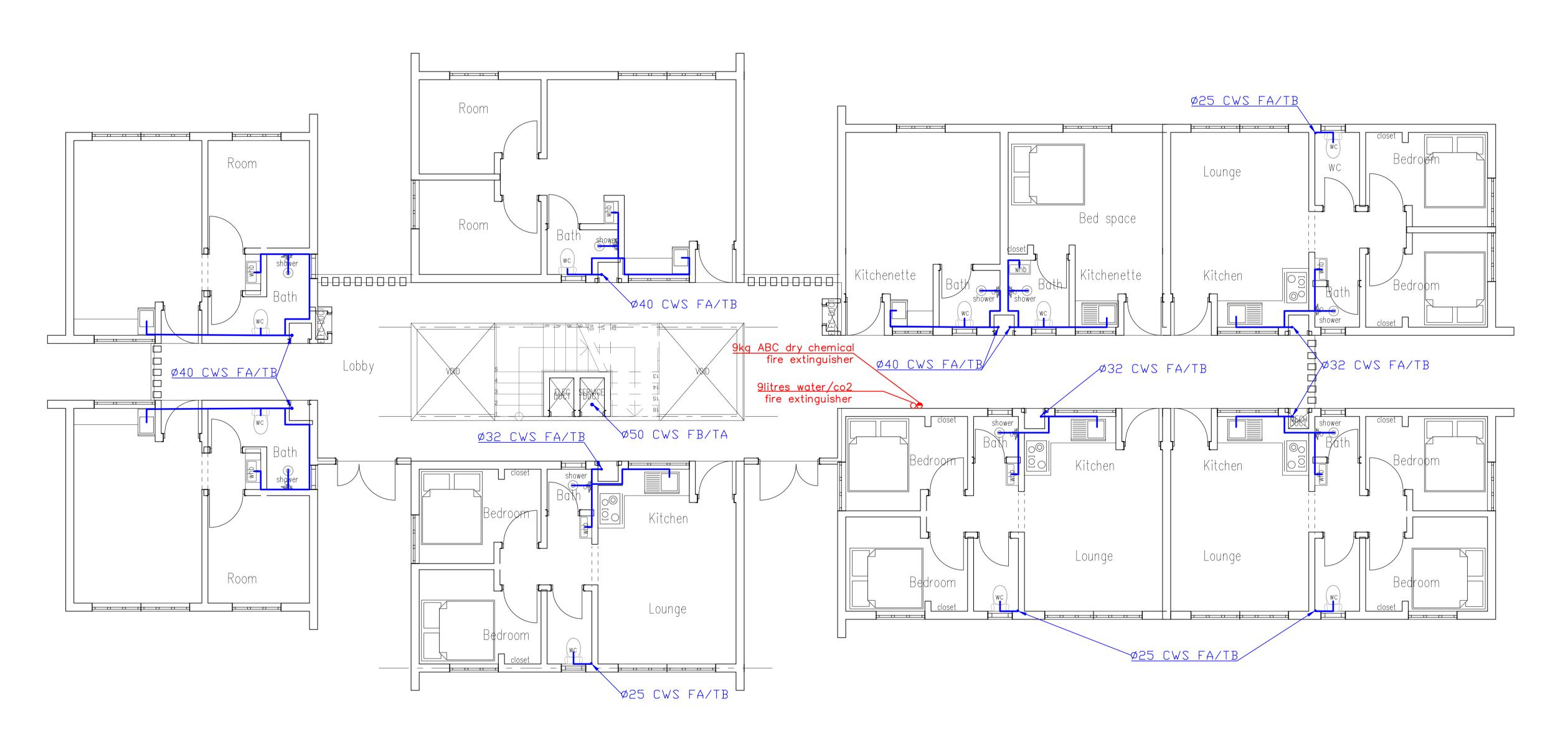
BLOCK A G+4 TYPICAL FLOOR PLUMBING AND FIRE FIGHTING PLAN
