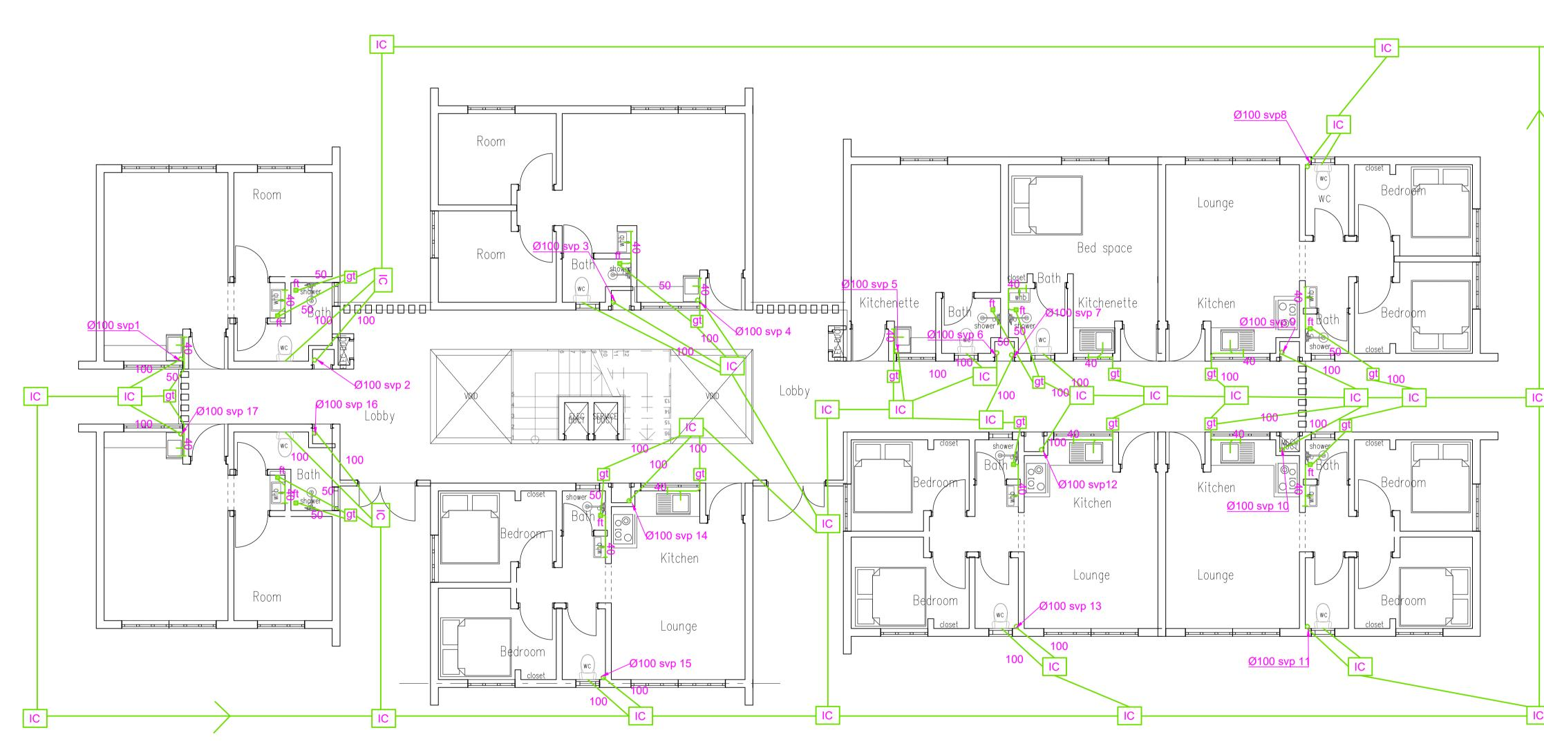
BLOCK A G+4 GROUND FLOOR DRAINAGE PLAN
